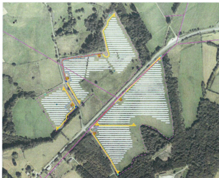
illustration 19 : implantation de la centrale en considération des lignes HTA
